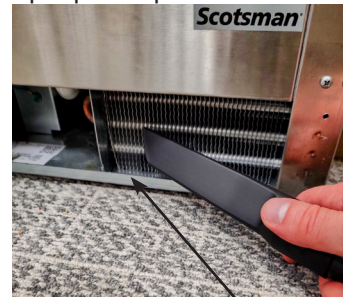
Surface du condenseur
